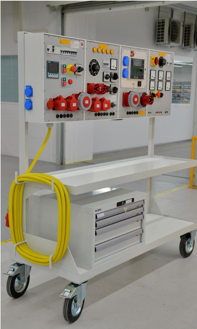
Unité de base, unité de contrôle pour câbles et unité de tension AC/DC incorporées sur une table de travail mobile avec tiroirs.
