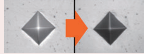
Beobachtetes Bild der Hinterschnittung (50x) Streichlichtreduzierung um den Hinterschnitt
