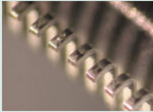
Beispiel: Höhe der Kontakte eines QFP
