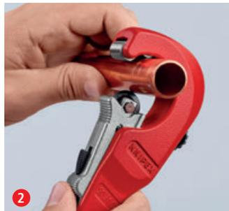
Schneirad mit QuickLock-Einhandschnellverstellung ans Rohr schieben: schnelle Einstellung an unterschiedliche Rohrdurchmesser
