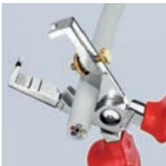
Induktiv gehärtete Scherschneide mit Präzisionsschliff zum quetschfreien Schneiden von Cu- und Al-Kabeln bis Ø 15 mm (5 x 2,5 mm<sup>2</sup>)
