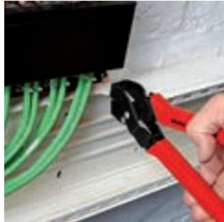
Mit der KNIPEX Auslinkzange lassen sich einfach, schnell und sauber die gebräuchlichsten Aussparungen in Kunststoffleisten und Kabelkanälen realisieren. Kein umständliches Aussägen oder Ausknabbern und aufwendiges Nacharbeiten
