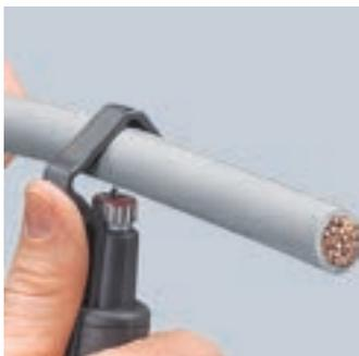
Ansetzen des Werkzeugs für Umfangsschnitt
