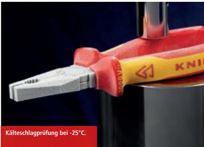
Kälteschlagprüfung bei -25°C.
