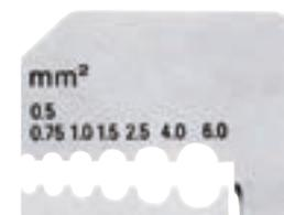
12 21 180: Drahtquerschnitte in mm<sup>2</sup>
