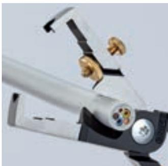
Induktiv gehärtete Scherschneide mit Präzisionschliff zum quetschfreien Schneiden von Cu- und Al-Kabeln bis Ø 15 mm (5 x 2,5 mm<sup>2</sup>)
