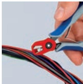
...das abgetrennte Werkstück verbleibt sicher im Abschnittfänger
