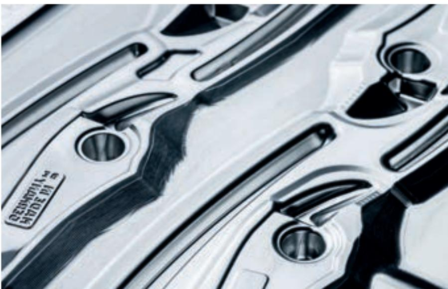
Schmiedegesenk für den Kraft-Seitenschneider mit angeschmiedeter Gelenkachse.
