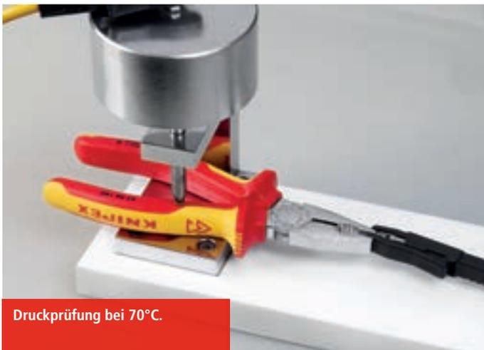
Druckprüfung bei 70°C.
