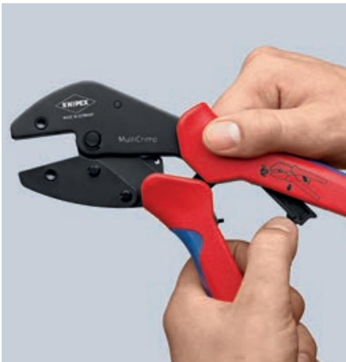
Wechselposition: Ausklappen des Service-Hebels für parallele Backenstellung
