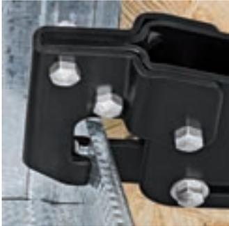
Das Stempelwerkzeug wird durch die Profilbleche gedrückt
